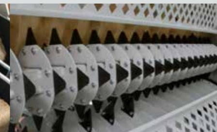
Цели с роликовыми звеньями, не требующие обслуживания с центральной системой смазки, режущие фрезы с регулируемой частотой вращения, патентованные калибровочные решетки и встречные ножи для специальной тонкой нарезки корма (35 или 69 мм)
