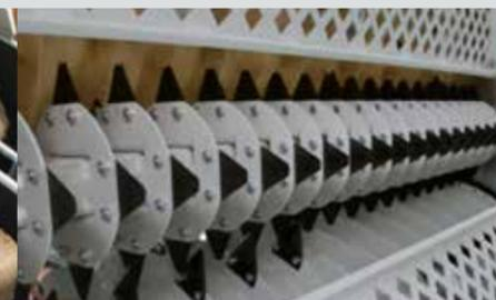
Chaînes à maillons ne nécessitant aucun entretien, avec graissage centralisé, fraises alimentées par convertisseur de fréquence, grille brevetée & contre-lames pour une découpe régulière (brins de 35 ou 69 mm)
